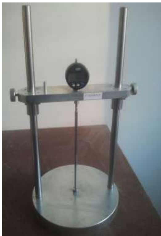
1 pav. Betono bandinių ilgio pokyčių matavimo prietaisas
